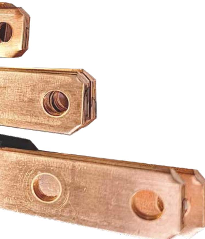
C-Flex besteht aus mehreren hochleitfähigen Kupferlamellen (Cu-HCP), wahlweise verzinkt oder blank, in Lamellendicken von 0,5 bis 1,0 mm. Die flexible Konstruktion ermöglicht einen zuverlässigen Anschluss – auch unter extremen Bedingungen.
